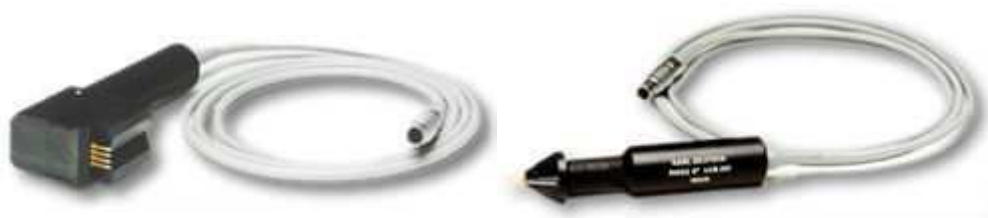
rys. 3 Sondy do pomiaru głębokości pęknięć: z głowicą pomiarową 90^\circ i z głowicą pomiarową 0^\circ
