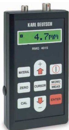
Miernik głębokości pęknięć RMG 4015
