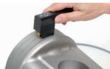
Pomiar pęknięcia kąowego
