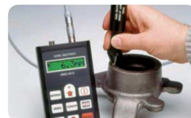
Pomiar pęknięcia na wąskiej powierzchni
